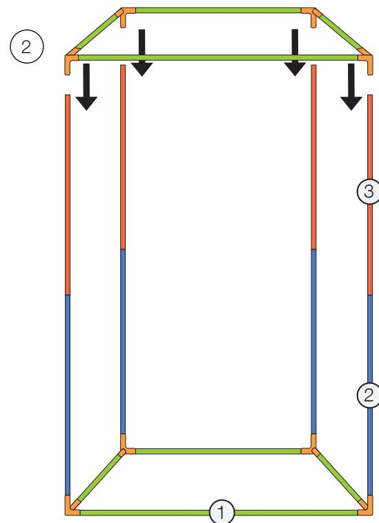
■ Assembler la partie inférieure du châssis, comme indiqué à l'aide des quatre connecteurs d'angle et des tiges 1,2,3,4 en vous assurant que les tiges soient bien insérées dans les connecteurs d'angle.
