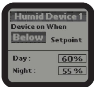
**2).** Lorsque l'appareil 1 est sélectionné, l'utilisateur peut définir le point d'humidité pour le mode Jour/Nuit pour l'appareil 1. Appuyez sur le bouton entrer et le texte ci-dessus ou ci-dessous clignotera. Appuyez sur le bouton haut ou bas pour changer entre le haut et le dessous. Enfin, appuyez sur le bouton entrer pour confirmer et enregistrer la modification. L'écran LCD affichera "Réglage enregistré".
