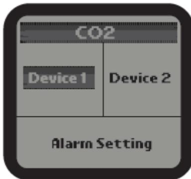
1). Sur la page de réglage, sélectionnez le sujet CO2, puis appuyez sur le bouton entrer pour accéder à la page de réglage du CO2. Utilisez le bouton haut ou bas bouton pour sélectionner l'appareil 1 ou l'appareil 2 ou le réglage d'alarme.
