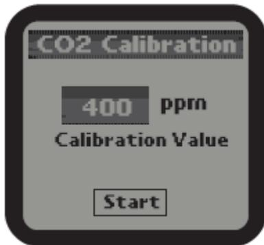
4). Calibrage du CO2 : Après avoir été utilisé pendant un certain temps, le capteur de CO2 peut devoir être recalibré en cas de tolérance. Appuyez sur Le bouton entrer et haut ou bas pour ajuster le niveau d'étalonnage si vous avez une référence précise. Sinon, le niveau recommandé sera de 400. Appuyez sur bouton démarrer pour commencer avec le processus d'étalonnage du CO2.
