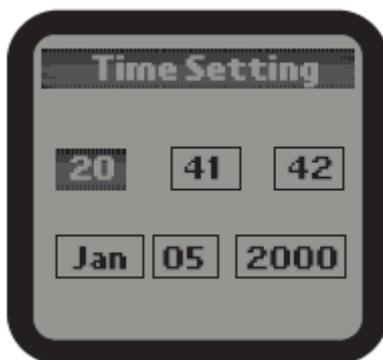
2). Réglage de l'heure : Appuyez sur les boutons haut ou bas, droite ou gauche pour sélectionner le sujet et appuyez sur entrée pour lancer le réglage. Appuyez sur haut ou bas pour changer et appuyez sur le bouton entrer pour sauvegarder. La 1ère ligne est pour l'heure (Heure-Minute-Seconde) et la 2ème ligne pour la date (Mois- Date-Année).
