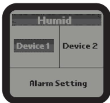
**1).** Sur la page de réglage, sélectionnez le sujet humidité, puis appuyez sur le bouton entrer pour accéder à la page de réglage. Utilisez le bouton haut ou bas pour sélectionner l'appareil 1 ou l'appareil 2 ou le réglage de l'alarme.
