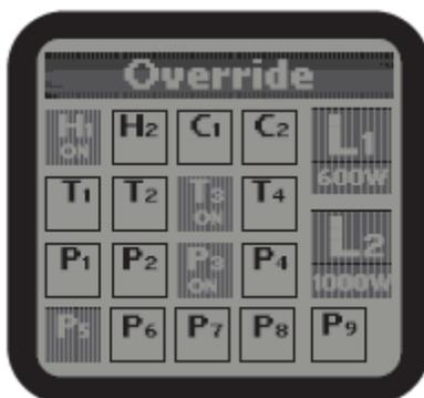
3). Remplacement : Lorsque la fonction Override est sélectionnée sur la page système, le curseur est clignotant. Utilisez haut ou bas, droite ou gauche pour passer à l'appareil que vous souhaitez
