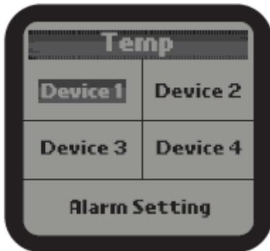
**1).** Sur la page De réglage, sélectionnez le sujet Temp, puis appuyez sur le bouton entrer (1) pour accéder à la page de réglage température. Utilisez le bouton haut (I) ou le bouton bas (C) pour sélectionner l'appareil ou le paramètre d'alarme.
