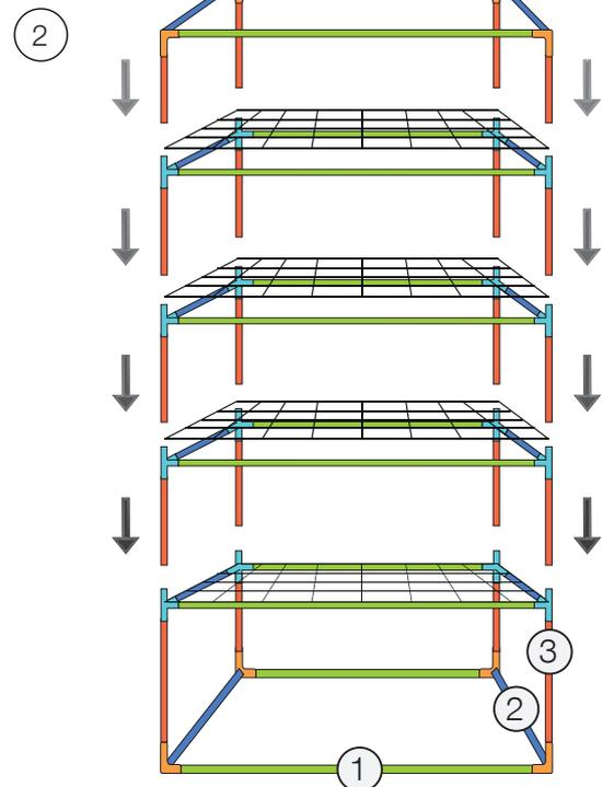
**A** - Assembler la partie inférieure du châssis, comme indiqué à l'aide des quatre connecteurs d'angle et des tiges 1,2,3 en vous assurant que les tiges soient bien insérées dans les connecteurs d'angle.
