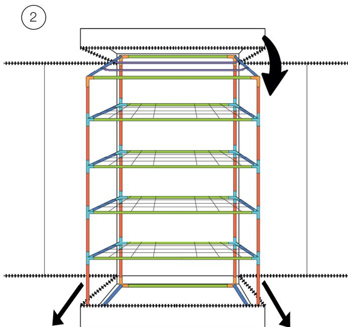
**FR** Faites glisser la tente sous la structure de la chambre et ajustez-la sur les 4 coins inférieurs puis supérieurs.
