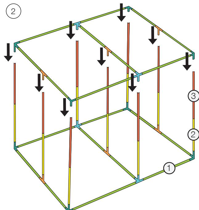
■ ■ Assembler la partie inférieure du châssis, comme indiqué à l'aide des neuf connecteurs d'angle et des tiges 1,2,3 en vous assurant que les tiges soient bien insérées dans les connecteurs d'angle.
