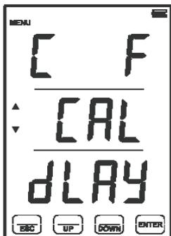
2. Lorsque l'appareil est allumé, maintenez la touche [MENU] enfoncée pendant 3 secondes pour sélectionner le mode [MENU].
