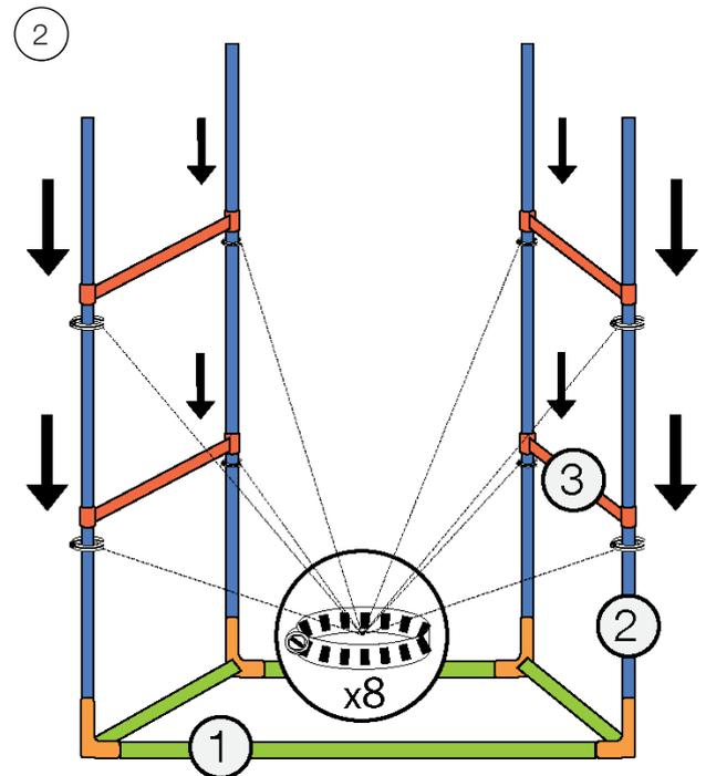
**■ ■** Assembler la partie inférieure du châssis, comme indiqué à l'aide des quatre connecteurs d'angle et des tiges 1,2 en vous assurant que les tiges soient bien insérées dans les connecteurs d'angle.
