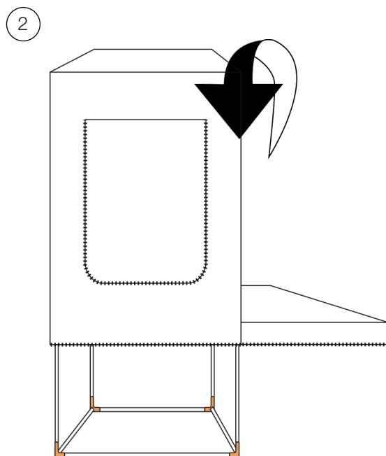
■ Faites glisser la tente sur la structure de la chambre et ajustez la sur les 4 coins supérieurs.
